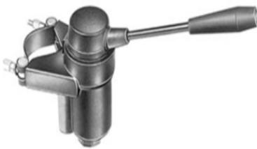
Se utiliza para el accionamiento manual del freno de aire del remolque. Resulta sumamente útil en días de lluvia especialmente en curvas ya que, por su gran sensibilidad en la frenada, evita el efecto tijera, muy frecuente en esos casos. La leva de accionamiento puede dejarse trabada en su punto máximo de frenada para que la válvula actúe como freno de estacionamiento.
