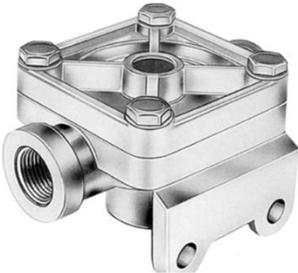
Esta válvula de descarga rápida instalada en el eje del vehículo entre las dos cámaras de freno cumple la función en el momento de desfrenado, de descargar velozmente a la atmósfera el aire de accionamiento de los frenos, sin tener que retornar hasta la válvula relay, facilitando que el tiempo de liberación de los mismos no supere el 1/2 segundo.
